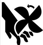
1.f. Não coloque suas mãos próximas à ventoinha do motor. Não tente acelerar o acionador ou a polia motriz empurrando a haste de comando do acelerador quando o motor estiver em funcionamento.
