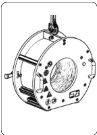
Fig. 7 No utilizar cuerdas de acero para elevar el calentador
