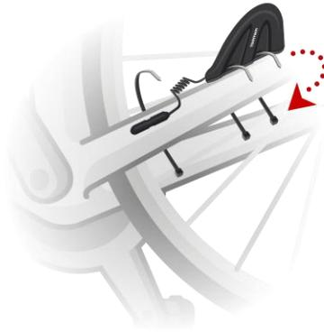
2. Conecte o ímã do raio a um dos raios da bicicleta. O ímã deve estar voltado para o suporte da corrente no qual você conectou o sensor do suporte da corrente.
