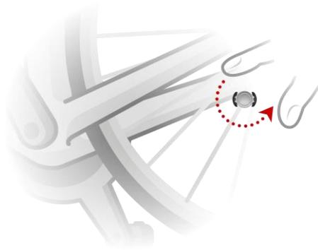
3. Ajuste a posição do ímã do raio e do sensor da corrente de forma que, quando a roda girar, o ímã do raio passe na ponta do corpo principal do sensor do suporte da corrente.
