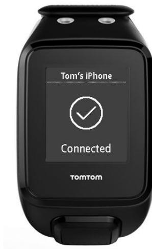
Desde que o aplicativo esteja ativo ou em execução em segundo plano no telefone celular ou no dispositivo móvel, o relógio automaticamente tentará se conectar quando houver uma nova atividade ou quando os dados do QuickGPSFix estiverem desatualizados.
