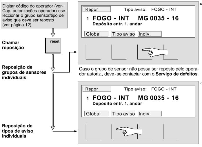
Ao accionar a tecla de função variável "Individual" serão repostos todos os sensores activados do grupo de sensores (p.ex. 0035) do tipo de aviso seleccionado.
