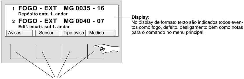
**Teclas processamento de avisos/teclas de função variável:**Com as 4 teclas de processamento de aviso/teclas de função variável podem ser chamadas as funções/ avisos indicadas no display por meio destas teclas . O texto respectivo acima da tecla no display dá indicações para o comando da respectiva tecla. Após pressionar a tecla serão mostrados no display demais avisos/funções com informações para os demais passos de comando.
