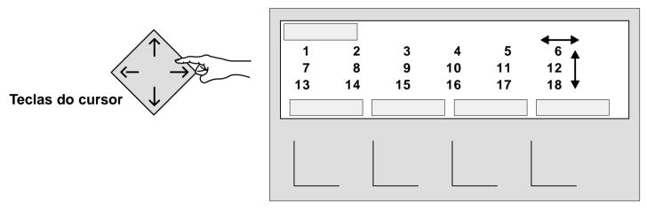
Com as teclas do cursor pode-se selecionar posições desejadas dentro do display (p.ex. para selecção de sensores, grupos de sensores ou funções).
