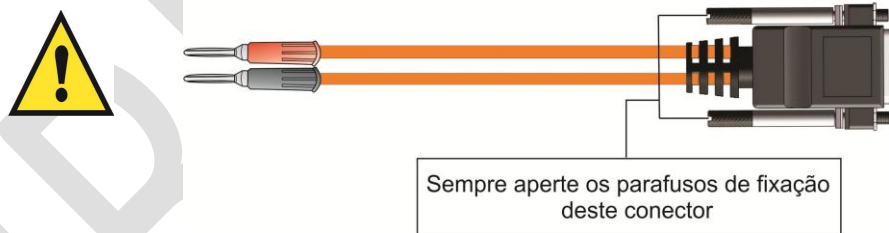
Figura 37. Atenção para a escolha dos cabos corretos para cada tipo de corrente.
