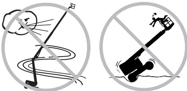
Dirija a máquina na posição retraída, com extremo cuidado e em baixa velocidade, ao passar por terrenos irregulares, detritos, superfícies instáveis ou escorregadias e próximo a buracos e declives acentuados.
