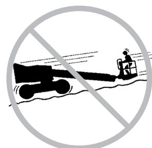
Limite a velocidade de operação de acordo com as condições da superfície, do congestionamento e da inclinação do solo, da localização de pessoas e de quaisquer outros fatores que possam provocar colisão.
