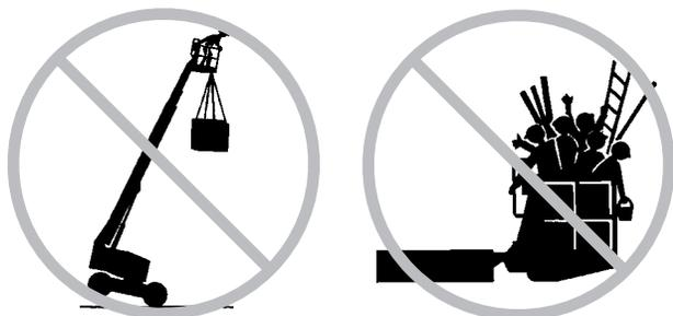
Não coloque escadas ou andaimes na plataforma ou apoiados em qualquer parte da máquina.
