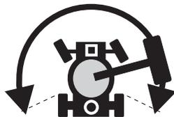
Para acionar, pressione o botão de habilitação de movimento e mova lentamente a alavanca de controle de movimento/direção, deslocando-a do centro.
