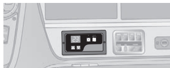
Comando de acionamento do ar condicionado e difusores de ar
