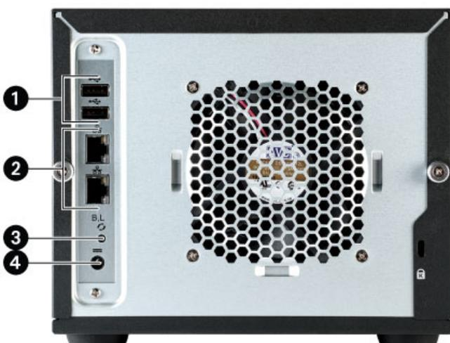
1. Conector USB 2.0 de alta velocidade: Dá suporte a dispositivos como armazenamento e impressoras USB. O Iomega StorCenter ix4-200d pode compartilhar três impressoras USB e três dispositivos de armazenamento USB com outros sistemas na rede.
