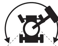
**Observação:** quando o sistema de habilitação de movimento estiver em uso, a máquina poderá movimentar-se no sentido oposto ao do movimento da alavanca de controle de movimento e direção.
