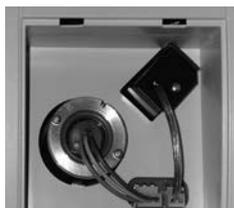
Desconecte o equipamento da fonte de energia. Remova a tampa do compartimento da pressionando-a levemente na borda e empurrando para frente e levante a tampa do compartimento. A lâmpada agora está acessível e pode ser trocada por uma nova lâmpada. Gentilmente puxe a lâmpada velha do suporte, solte os parafusos de fixação e retire a lâmpada. A inserção da nova lâmpada é feita de modo inverso.
