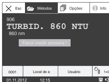
A medida de turbidez nefelométrica é selecionado e o comprimento de onda ajustado automaticamente. Meça a amostra seguindo as instruções na tela.
