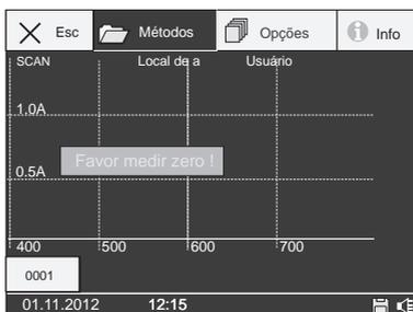
5. Insira a cubeta com o valor de zero no espectrofotômetro. Pressione  para iniciar a linha de base (use o mesmo tamanho de cubeta para a amostra, por exemplo, 10 mm)
