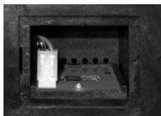
Desconecte o equipamento da fonte de energia. Coloque o instrumento em uma superfície macia com a face inferior virada para cima. Abra a peça que protege as lâmpadas. Cuidadosamente puxe o plug do circuito. Solte os parafusos que seguram a placa de circuito e remova do local. Insira uma nova peça no local e ajuste os contatos. Insira a peça que protege o local.
