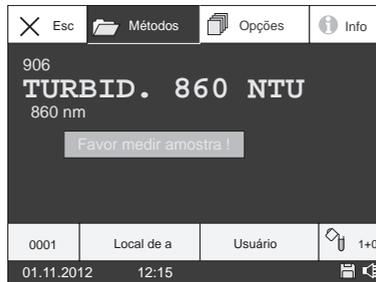
A medida de turbidez nefelométrica é ativada e o comprimento de onda é ajustado automaticamente. Então, realize a medida da amostra, seguindo as instruções exibidas na tela.
