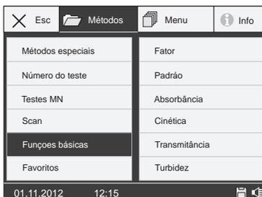
Uma vez completa as funções fotométricas básicas, há múltiplas opções no menu principal. Pode-se inserir o número da amostra, local da amostra, usuário e diluição, ou transferir a função específica para uma lista de favoritos. Ainda, é possível exibir a absorvância.
