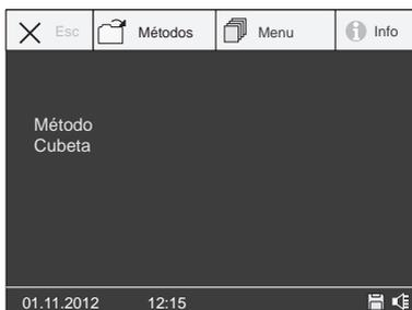
2. Insira o tubo com o código de barras no fotômetro. O número, nome e comprimento de onda do teste são mostrados na tela.
