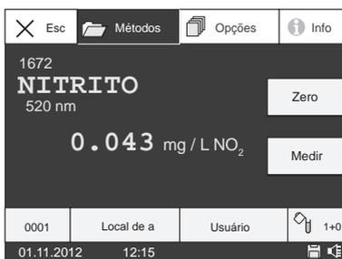
Na parte inferior da tela, uma barra de menus é exibida possibilitando a inserção de um número específico e localização da amostra, e possível diluição. As inserções são exibidas imediatamente.
