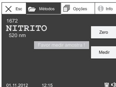
4. Insira a cubeta retangular com a solução amostra no espectrofotômetro. Pressione  para iniciar a medida.
