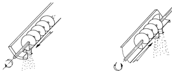
Figura 23: Sentido de rotação e transporte para roscas transportadoras
