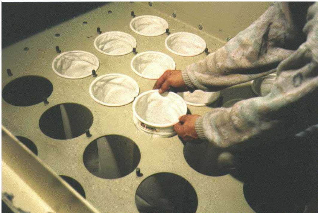
Figura 32: Montagem das mangas
