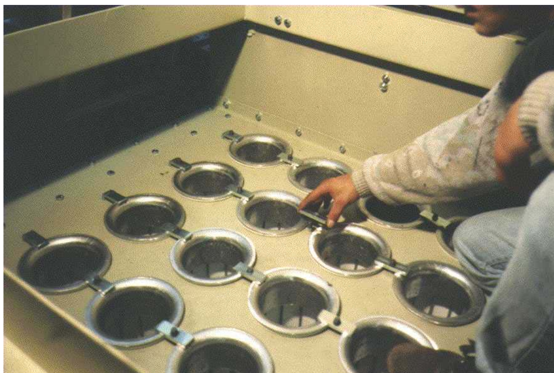
Figura 27: Colocação das barras de tensão
