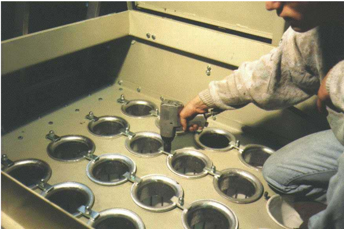
Figura 28: Aparafusando as barras de tensão
