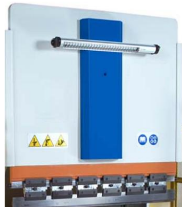
Figura 80 – Máquina com parte metálica em azul, de acordo com a NR-12.
