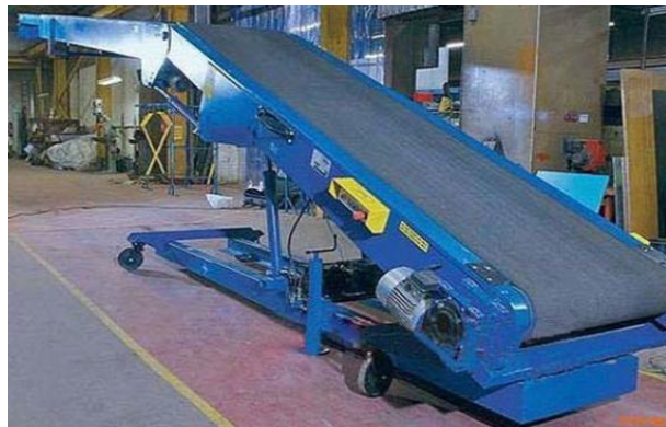
Figura 73 – Transportador de materiais de correia.
