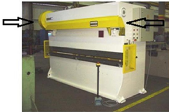
Figura 79 – Proteção contra movimentos perigosos, na cor amarela.
