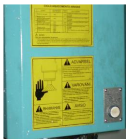
Figura 77 – Sinalização de segurança, centro de usinagem.
