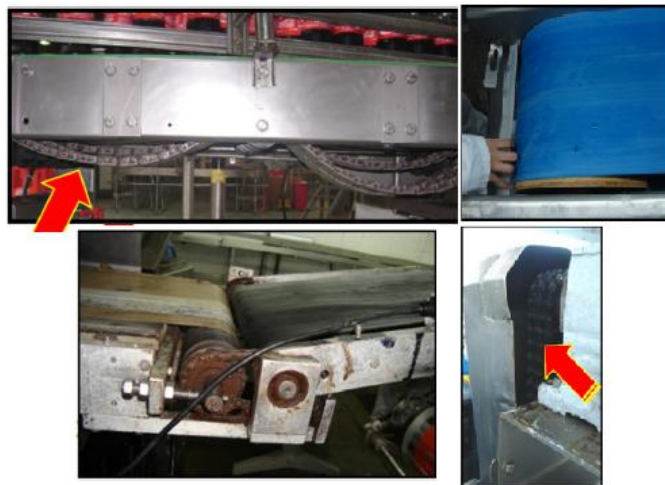
Figura 71 – Pontos de risco, transportadores de materiais.
