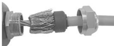
Figura 28: Ligue a blindagem no bucim do cabo do encoder
