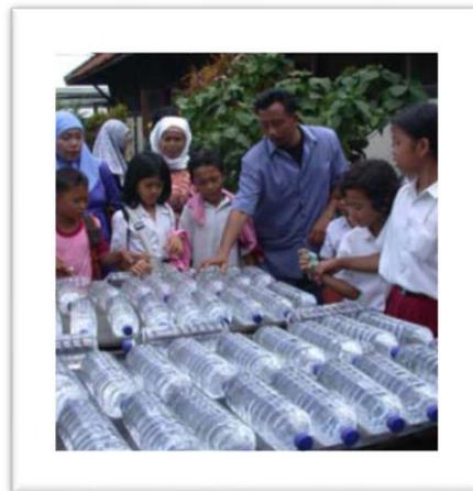
Figura 8.2 Desinfecção Solar da água (SODIS) (Fonte: CAWST, 2009).
