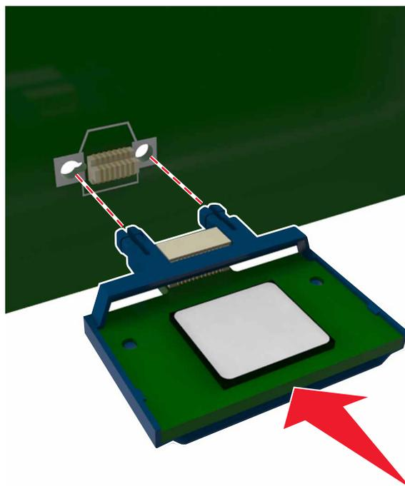
**Aviso—Dano Potencial:** A instalação incorreta da placa pode causar danos à placa e à placa do controlador.
