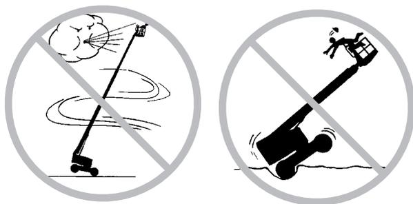
Dirija com extremo cuidado e em baixa velocidade com a máquina na posição retraída ao passar por terrenos irregulares, detritos, superfícies instáveis ou escorregadias e próximo a buracos e declives acentuados.
