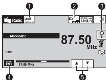
Sintonia manual (passo a passo) utilizando os botões
