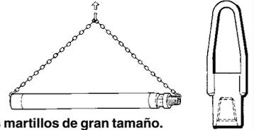
Cuando levante el martillo usando un equipo de elevación mecánico, coloque una eslinga como se muestra en la fig. Alternativamente, se puede roscar en la pieza superior un acoplamiento de cáncamo de elevación.
