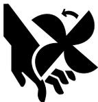
7.f. Não coloque suas mãos próximo à ventoinha do motor. Não tente acelerar o acionador ou a polia motriz empurrando a haste de comando do acelerador quando o motor estiver em funcionamento.
