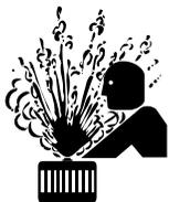
7.h. Para evitar queimaduras, não remova a tampa de pressão do radiador quando o motor estiver quente.
