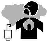
7.b. Opere os motores em locais abertos e bem ventilados, ou ventile as emissões do motor para fora do recinto.
