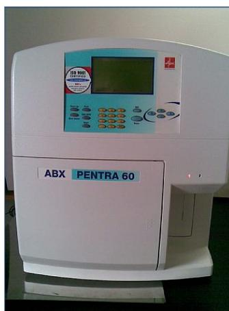
**Figura 3 - Contador Hematológico Automático ABX Pentra 60**
