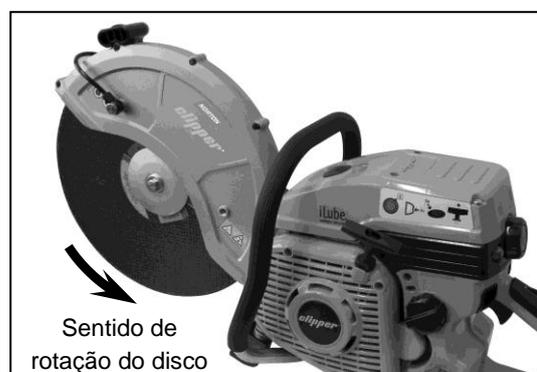
O sentido de rotação do disco é sempre segundo a seta acima. Ao instalar o disco, deve-se verificar a direção de corte deste para que seja instalado corretamente.
