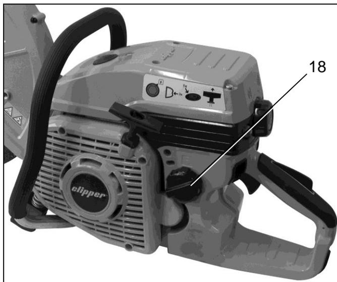
O modelo **CP514-350** é equipado com um tanque de combustível (18). Neste tanque deve-se fazer a mistura dos seguintes componentes:
