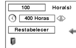
Utilize os botões ◀▶ ponto para ajustar o contador. Seleccione de (Desligado/400 Horas/ 700 Horas/ 1000 Horas) dependendo do ambiente de utilização.
