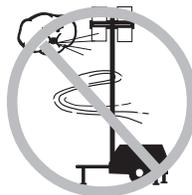
Não eleve a torre quando a velocidade do vento for superior a 100 km/h. Não aumente a área da superfície da plataforma ou da carga. O aumento da área exposta ao vento reduz a estabilidade da máquina.
