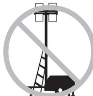
Não coloque escadas ou andaimes apoiados em qualquer parte da máquina.
