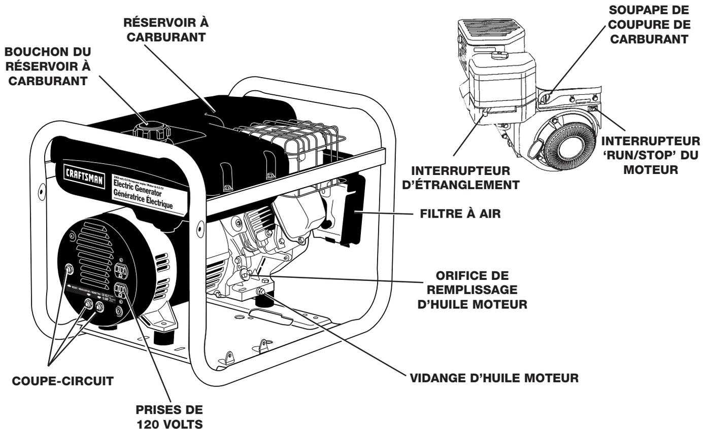
**RÉSERVOIR À CARBURANT** – Capacité de 4 gallons US (15,1 litres).
