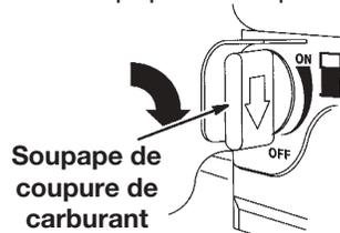
**REMARQUE :** Fermer les soupape de coupure de carburant lors du transport du moteur, afin d'empêcher toute fuite.
