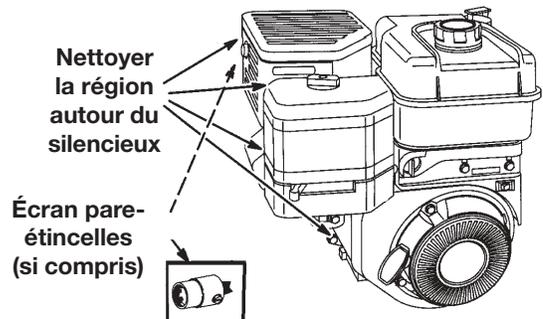
Retirer l'écran pare-étincelles à toutes les 50 heures de service pour l'inspection et le nettoyage. Le remplacer s'il est endommagé.
