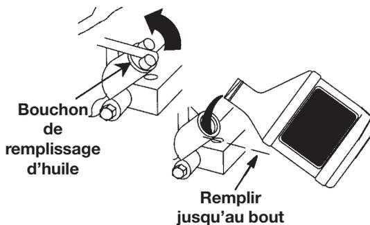
**REMARQUE :** Lorsqu'il faut ajouter de l'huile au carter du moteur, utiliser une huile détergente de haute qualité, de grade SAE 30 et de catégorie 'Pour service SF, SG, SH'. Ne pas utiliser des additifs spéciaux. Choisir la viscosité de l'huile selon les températures prévues lors de l'utilisation de l'appareil.
