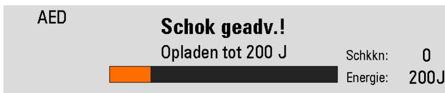
A análise de ritmo cardíaco continuará quando o equipamento for carregado. Se uma alteração no ritmo for detectada antes de o choque ser aplicado e o choque não for mais adequado, a energia armazenada será removida internamente.
