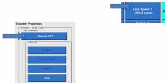
Figura 47 Botões de desligar a inversão e de velocidade da máquina principal
