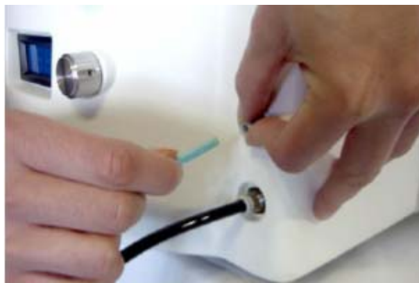
Figura 12: Remoção da Tubulação de um Acessório de Desconexão Rápida
