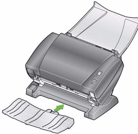
**OBSERVAÇÃO:** Se o clipe não estiver instalado, você pode instalá-lo, deslizando-o para o scanner entre os compartimentos da parte central e encaixando-o. Depois de ter instalado o clipe, não há necessidade de removê-lo.
