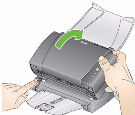
3. Deslize a extensão da bandeja de saída para baixo da plataforma do scanner ao longo da guia central e empurre-a novamente até que ela esteja firmemente encaixada.
