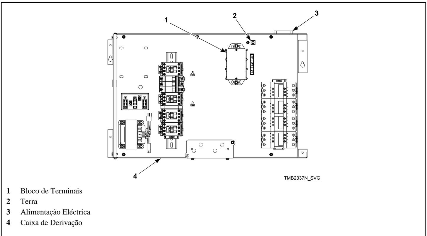
**Figura 19 Localizações da Ligação à Terra e do Bloco de Terminais para Modelos eléctricos**
