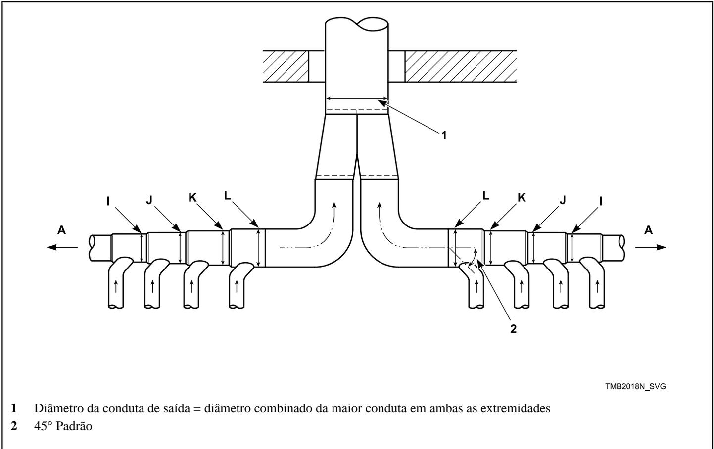
Figura 14 Dois conjuntos de coletor
