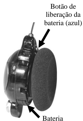
Figura 5. Botão de liberação da bateria no fone de ouvido
