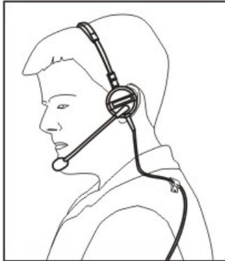
O headset consiste em um fone, um microfone, um grampo para roupa e um cabo. O headset é conectado à extremidade do cabo de áudio do cabo de voz, que é conectado ao HX2.
