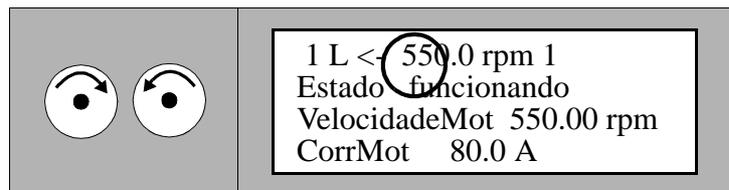
Quando o senso de rotação é modificado enquanto o motor está funcionando, a velocidade irá automaticamente rampar para zero e o motor irá acelerar na direcção oposta da velocidade pré-definida. A direcção da seta no visor muda o novo senso de rotação, se o motor alcançou a velocidade zero.
