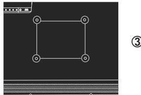
**Nota:** O suporte de montagem em parede 200mm x 200mm e os parafusos M6 não estão inclusos.
