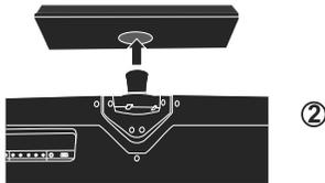
3. Gentilmente empurre a base em direção à TV até ouvir um click, indicando que o mecanismo de trava esteja no lugar. Cuidado para não quebrar as travas (02) que ficam no acoplador na hora de acoplar a base.
