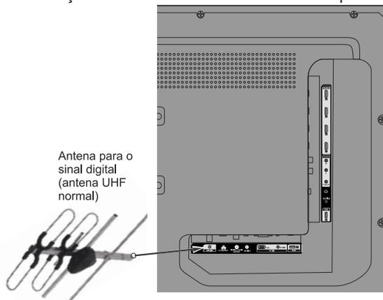
3. Conecte o cabo da antena digital ou analógica ou TV a cabo no soquete **ANT IN** na parte traseira do aparelho (veja figura acima).
