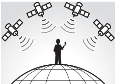
La medición de una posición se denomina “seguimiento”. Un receptor GPS puede localizar la longitud y latitud de la posición recibiendo señales de tres satélites.
