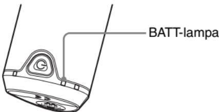
GPS-enheten drar mer batteriström under sökning än under spårning. Även om GPS-enheten beräknar den återstående batteriströmmen och gör så att BATT-lampan börjar blinka rött under sökning, kan det hända att det går att fortsätta att använda GPS-enheten betydligt längre när den går över från sökning till spårning.
