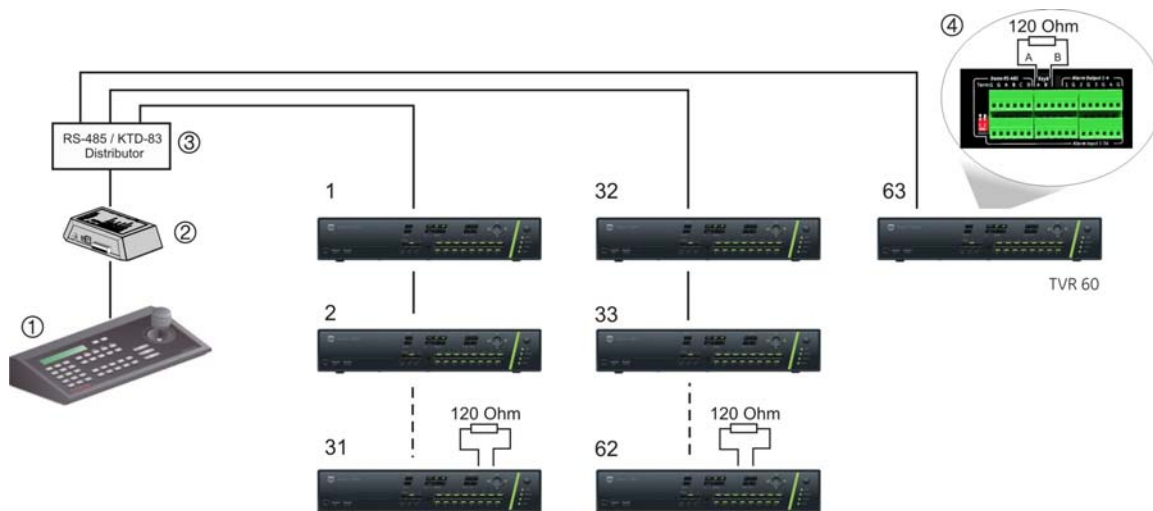
Figura 5: Expandir o sistema com um distribuidor de sinal RS-485
