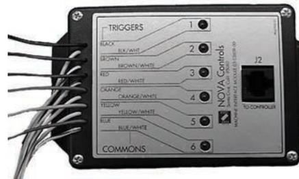
1. Prenda a IM ao chassis da lavadora, tanto na área da fiação como em uma caixa de passagem montada externamente.
