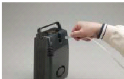
Figura 7: Conexão da Cânula à tomada de oxigênio do FreeStyle
