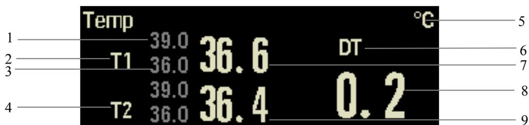
1. Limite máximo do alarme de Temp
