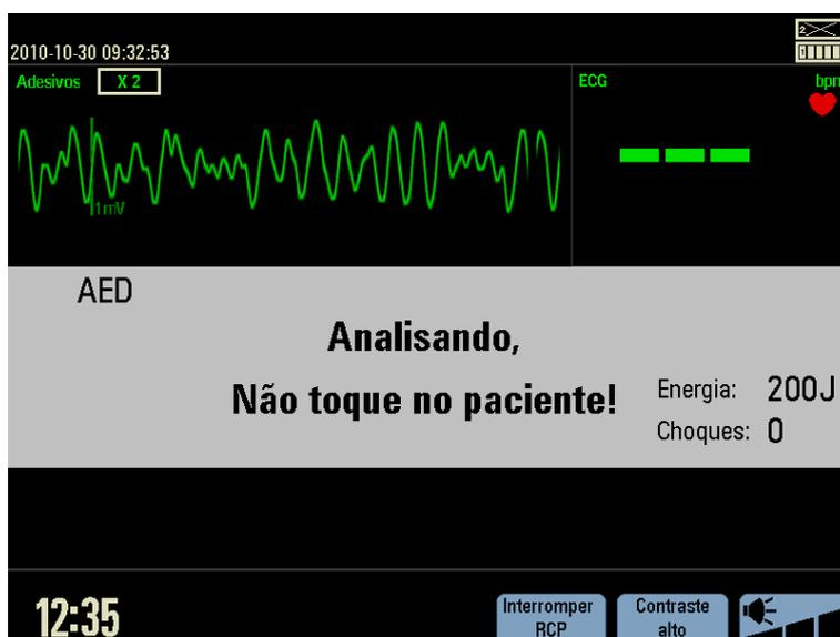
No modo AED, os números da FC e uma curva de ECG obtida das pás de eletrodos multifuncionais são exibidos. Abaixo do ECG fica a área de informações que exibe o modo de desfibrilação, mensagens de aviso, a energia selecionada e um contador de choques.
