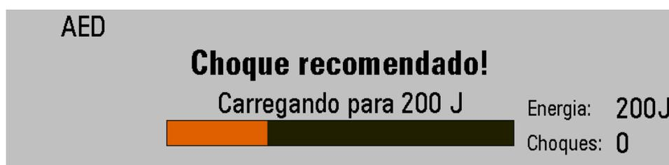
A análise de ritmo cardíaco continuará quando o equipamento for carregado. Se uma alteração no ritmo for detectada antes do choque ser aplicado e o choque não for mais adequado, a energia armazenada será removida internamente.
