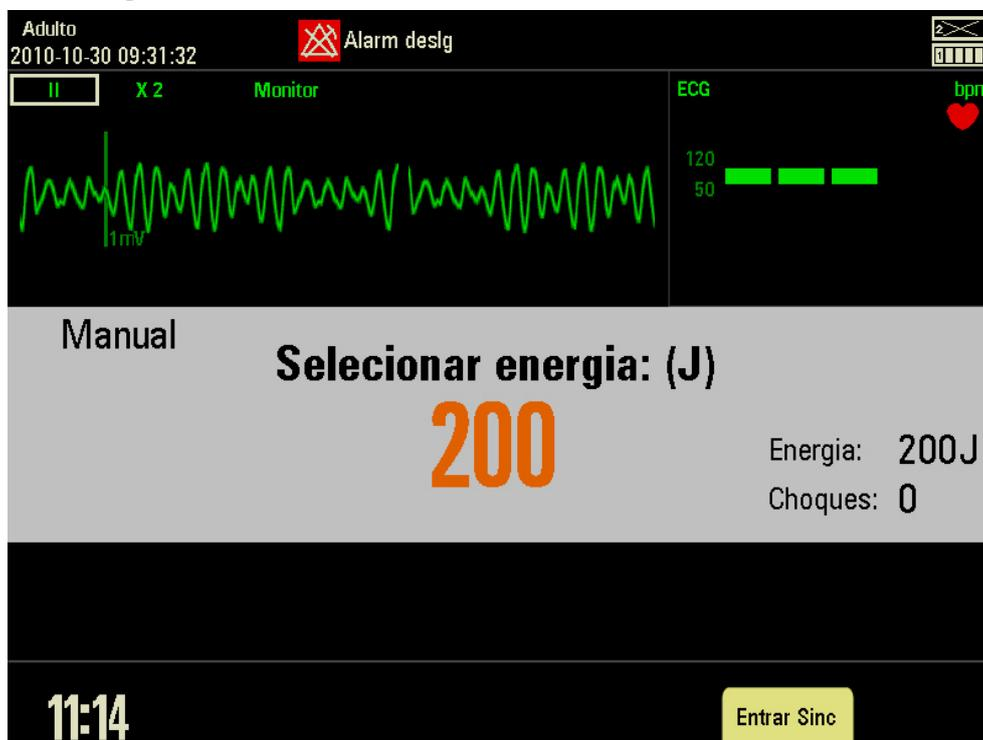
Na área de ECG ampliada, uma curva de ECG e os parâmetros relacionados são exibidos. No meio da tela, são exibidos o modo de desfibrilação, o ícone de sincronização, mensagens de aviso, a energia selecionada e um contador de choques.
