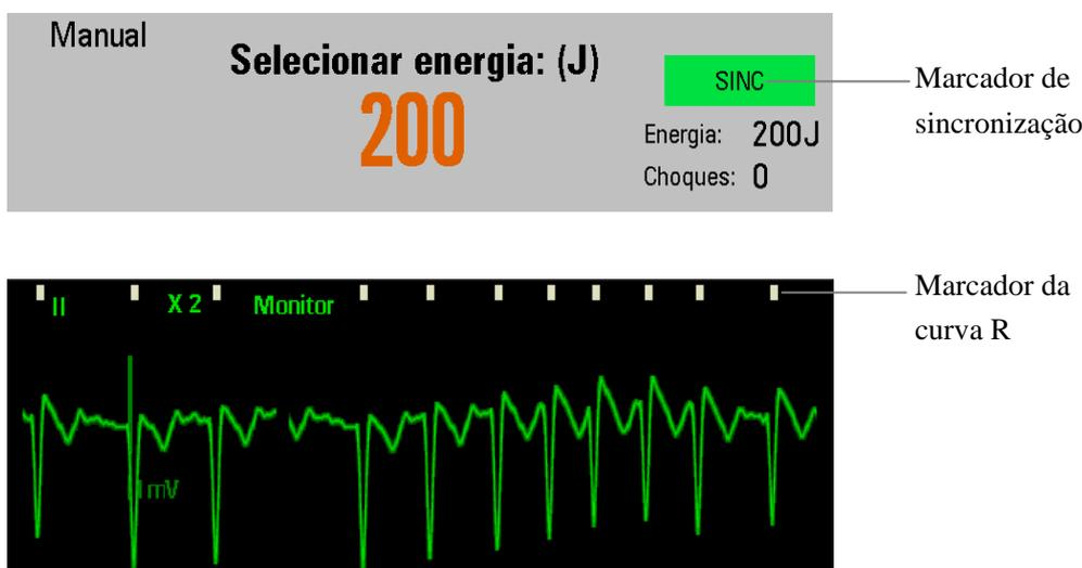
Você pode monitorar o ECG por meio de pás de eletrodos multifuncionais, almofadas externas ou eletrodos conectados a um cabo de ECG de 3 ou 5 derivações. O choque será aplicado por meio das pás ou almofadas.
