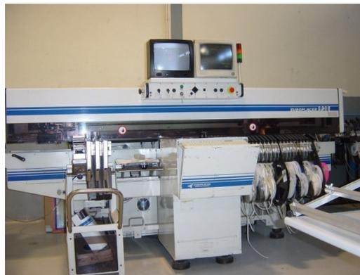
Figura 4. 1 – Máquina de Inserção SMD
