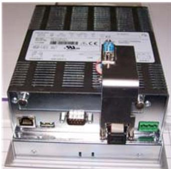
3. Fixe o módulo de comunicação com os dois parafusos recartilhados.
