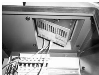
1. Levante um pouco o painel de comando de um dos lados e introduzir um clipe (veja as setas) do lado oposto. Depois disso, é possível retirar o painel de comando para fora do recorte, de modo que as ligações fiquem a descoberto.
