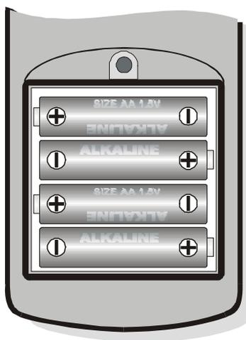
**Depois de substituir as baterias, os parâmetros data, hora, taxa baud, tipo de sonda, intervalo de impressão e de registro, devem ser configurados novamente: a fim de simplificar esta operação, ao inserir novas baterias o instrumento liga automaticamente e pede estes parâmetros na seqüência.** Para ir para o próximo item pressione ENTER, para retornar ao modo de medição, pressione MENU.
