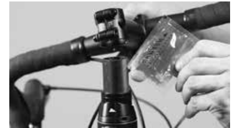
Espalhe massa de carbono para montagem sobre o tubo do garfo
