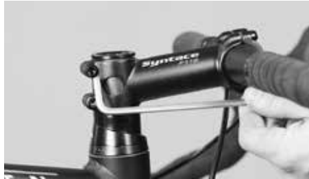
Solte os parafusos laterais do avanço
