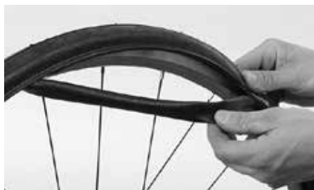
Puxar a câmara-de-ar do pneu para fora
