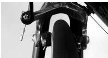
Controle da concentricidade com os travões
