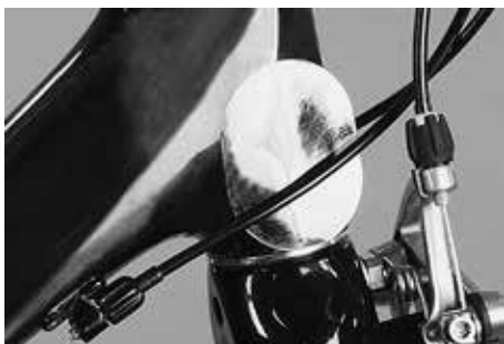
Autocolantes especiais protegem o carbono de danos
