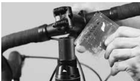
Espalhe massa de carbono para montagem sobre o tubo de garfo
