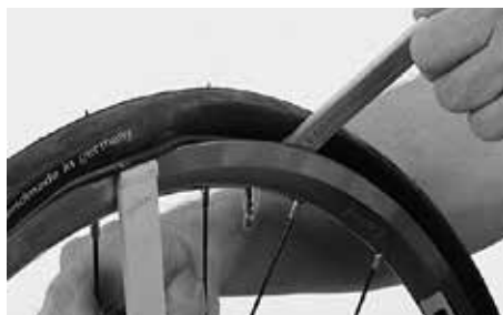
Aplicação da alavanca de montagem e alavancar do flanco do pneu sobre o friso do aro
