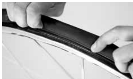
Pressionar o pneu para o meio do aro
