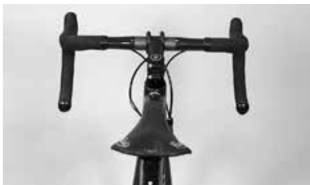
Examine o selim e o tubo superior atentamente com o olhar, para garantir que o selim não está desalinhado
