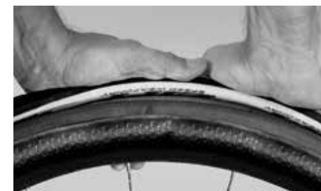
Empurre o pneu para o lado até se formar um intervalo
