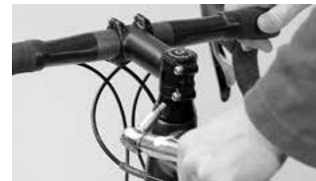
Reaperte os parafusos laterais de aperto do avanço com a chave dinamométrica
