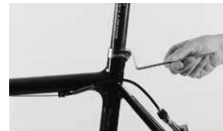
Para ajustar a altura do selim, tem que soltar o parafuso do espigão do selim do aperto do selim
