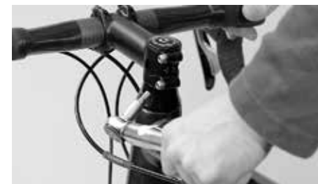
Aperte novamente o avanço com os valores de torque prescritos
