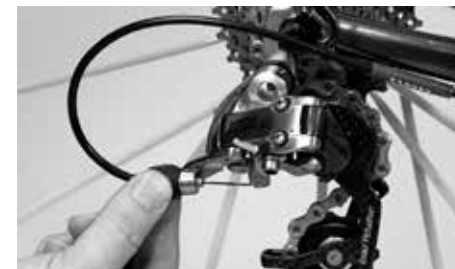
Reajuste da tensão do cabo das mudanças com o parafuso de ajuste, no desviador traseiro
