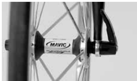
A alavanca do aperto rápido deve estar mais ou menos paralela relativamente à roda e não deve ficar em pé lateralmente
