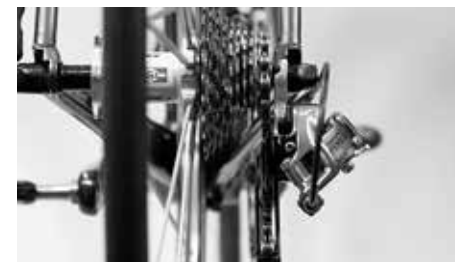
Observe por detrás o corpo da cassette e repare se as roldanas do desviador se encontra exactamente debaixo dos dentes afiados do pinhão certo
