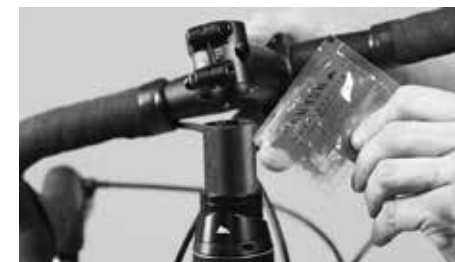
Aplique, se necessário, massa de carbono para montagem no tubo do garfo ou no guidador
