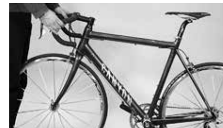
Tente rodar o guidador contra a roda dianteira e contra o avanço
