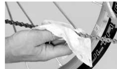
Limpe a corrente de sujidade e óleo com um pano
