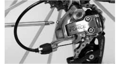
Para ajustar a distância entre a caixa das roldanas e a cassette, enrosque o parafuso que está apoiado na testa da ponteira
