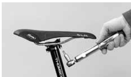
Aperte os parafusos, alternadamente e de forma homogênea, com os valores de torque prescritos
