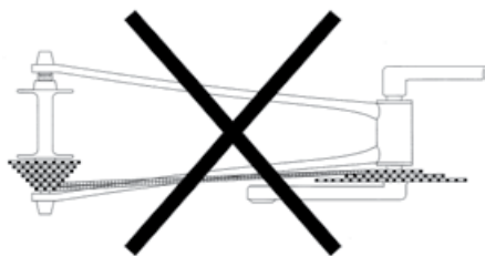
Incorreto andamento da corrente - corrente engata no prato menor à frente, e no pinhão menor atrás
