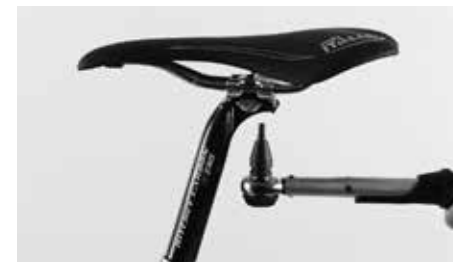
Aperte os dois parafusos alternadamente e de forma homogénea, não exceda jamais o valor de torque máximo prescrito
