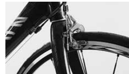
Controle a concentricidade através dos calços dos travões
