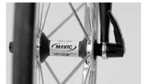
Verifique se as rodas ainda estão bem fixadas nas ponteiras
