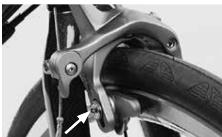
Para o ajuste em altura, aperte o parafuso de fixação do calço com o valor de torque prescrito
