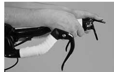
Manípulos de mudanças situados nas extremidades do guiador
