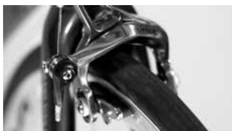
Controle da concentricidade recorrendo aos travões
