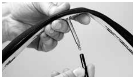
Montagem de extensão de válvula
