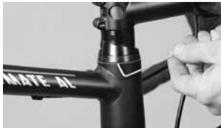
Gire agora o parafuso do ajuste da caixa de direção no sentido contrário
