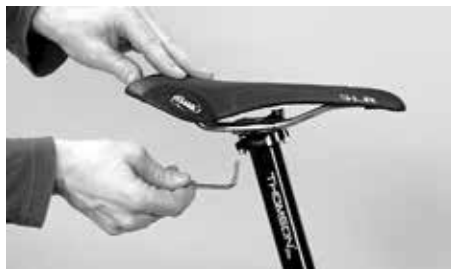
Desaperte os dois parafusos, dando no máximo 2 a 3 voltas
