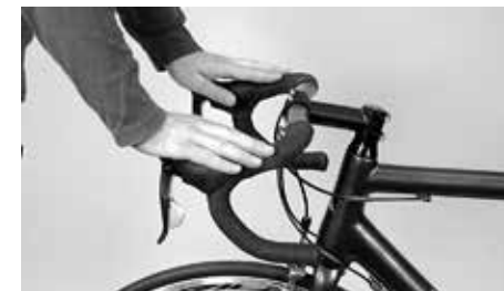
O guiador não deve mover-se com um empurrão forte para baixo
