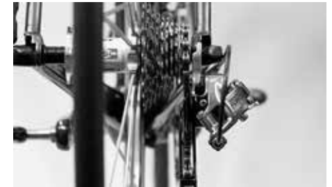
Antes da desmontagem da roda traseira, engatar a corrente no pinhão menor de todos
