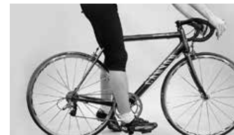
Quando o calcanhar está sobre o pedal, o qual se encontra na posição mais baixa, a perna tem que estar completamente esticada
