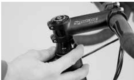
Controle a folga na caixa de direção, colocando os dedos à volta do casquilho, e empurre a sua Canyon para a frente e para trás, com o travão acionado
