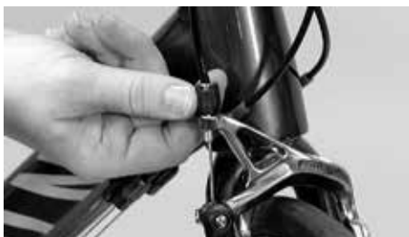
Com a porca serrilhada é possível alterar minimamente o curso livre necessário da manete
