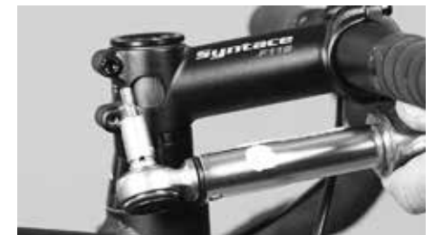
Enrosque todos os parafusos de fixação do avanço com uma chave dinamométrica, segundo as recomendações
