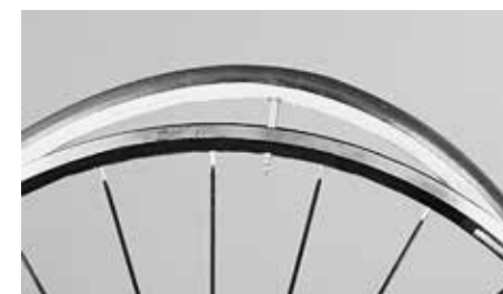
Coloque a válvula, do pneu levemente cheio, na perfuração do aro
