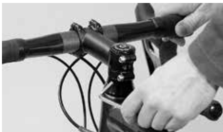
Solte os parafusos laterais do avanço
