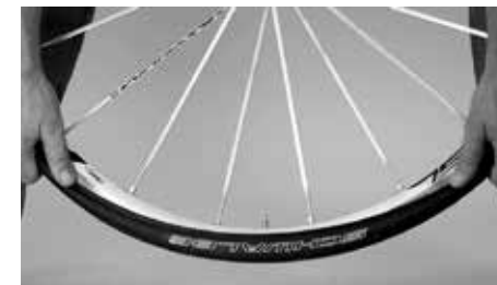
Empurrar o pneu, com a mão, para cima do aro
