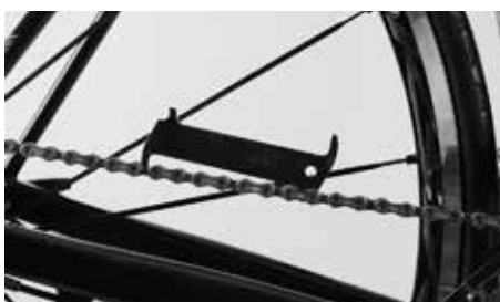
Medição profissional do desgaste
