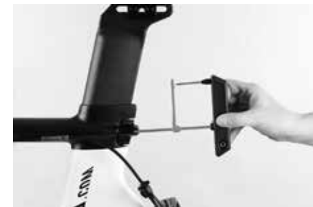
Enrosque ambos os parafusos com uma chave dinamométrica
