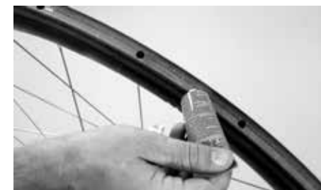
Aplicação da cola cimento para pneus, diretamente com o tubo
