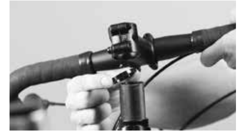
Retire as anilhas espaçadoras
