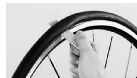
Com uma alavanca de montagem consegue-se alavancar o pneu
