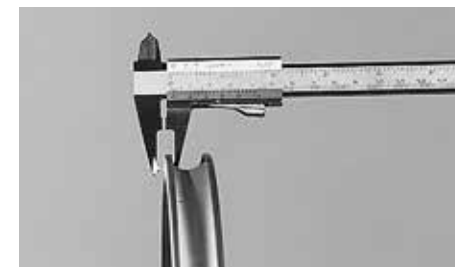
Mande inspecionar a espessura das paredes dos seus aros, o mais tardar após ter mudado o segundo jogo de calços de travões
