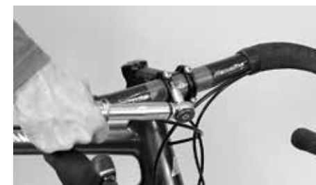
Aperte novamente os parafusos com os valores de torque prescritos
