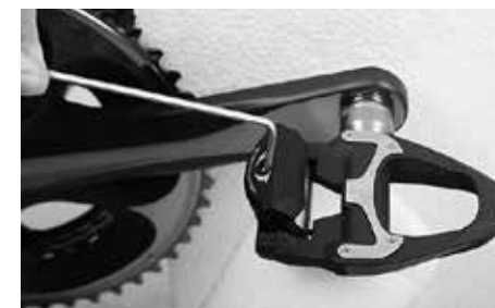
Ajuste da força de encaixe dos pedais
