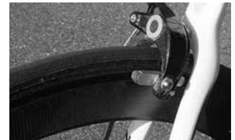
Os aros de carbono requerem calços de travão especiais de acordo com as instruções do fabricante das rodas
