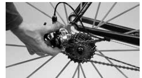
Na desmontagem da roda traseira, puxar o desviador traseiro um pouco para trás
