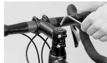
Ajuste a folga dos rolamentos com o parafuso de ajuste, introduzido por cima, após ter soltado os parafusos laterais de aperto
