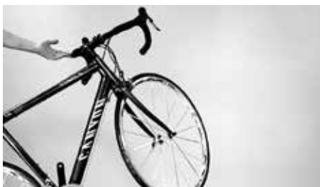
Examine a facilidade de viragem da caixa, levantando a roda dianteira e verificando se se deixa virar com facilidade
