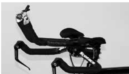
Manípulos de mudanças situados nas extremidades do guidador acionam o desviador traseiro e o desviador dianteiro
