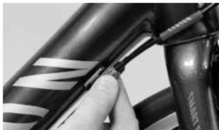
Reajuste da tensão do cabo das mudanças com o parafuso de ajuste, no quadro
