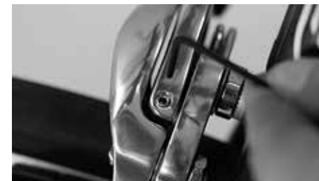
Gire o pequeno parafuso, até os calços, à esquerda e à direita, terem a mesma distância relativamente ao aro
