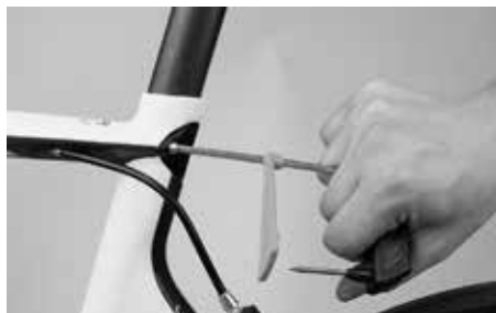
Enrosque ambos os parafusos com uma chave dinamométrica
