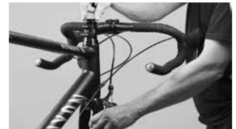
Coloque a tampa terminal, carregue-a de encontro ao garfo, agarre-o, e aperte depois o avanço ajustado com os valores de torque prescritos
