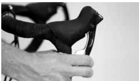
A manete do travão não deve poder ser puxada até ao guiador
