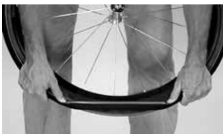
Empurre o pneu com os polegares por cima do friso do aro
