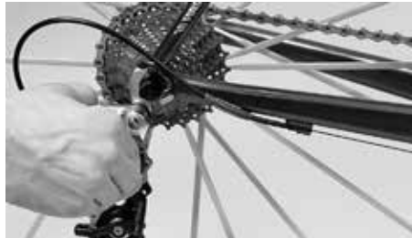
Certifique-se de que o desviador traseiro não pode entrar em contacto com os raios
