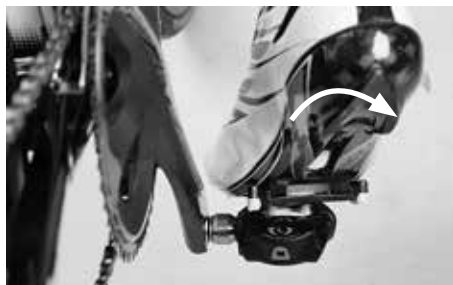
O desencaixe dos pedais é feito virando o calcanhar para fora
