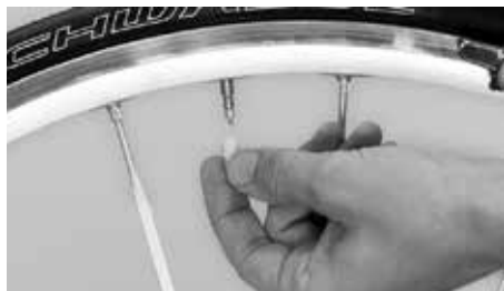
Desenroscar da tampa de plástico
