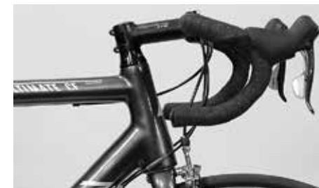
A parte direita da barra inferior deve estar, ou paralela ao chão, ou levemente inclinada para baixo
