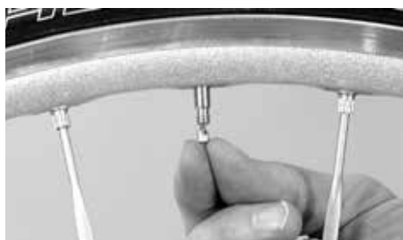
Na válvula Presta a válvula tem que ser desenroscada
