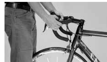
Tente rodar o guidador contra a roda dianteira
