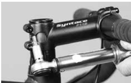
Controle os parafusos laterais de aperto do avanço com uma chave dinamométrica, segundo as recomendações escritas
