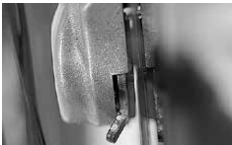
Controlo do desgaste das pastilhas
