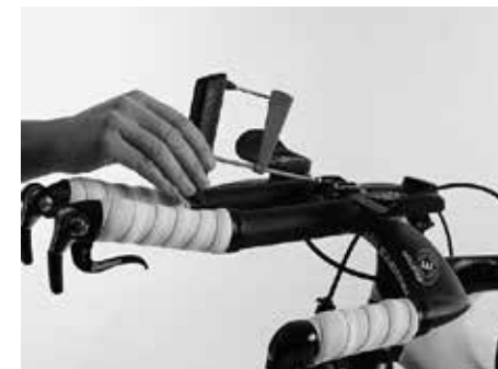
Montagem do guiador com a chave dinamométrica da Canyon
