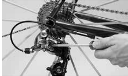
Delimite o curso do desviador traseiro com os parafusos de fim de curso
