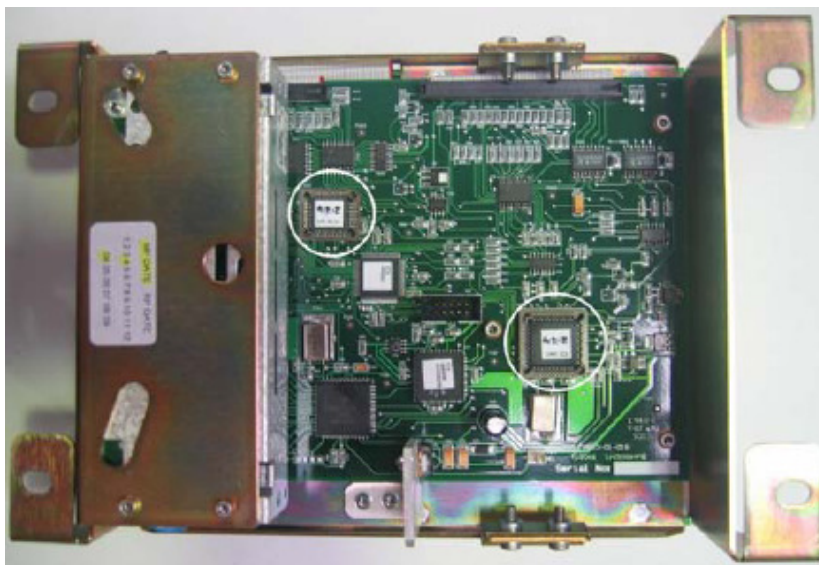
Figura 13-1: Localização EPROMs IC2 (secundário) e IC16 (primário)
