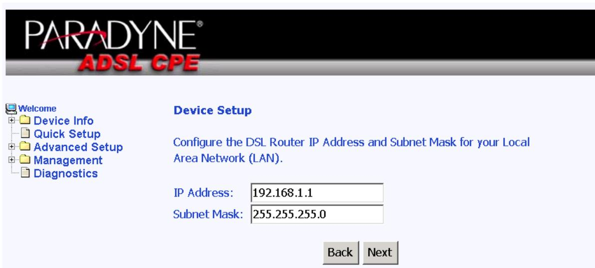
Figura 5.4 Configuração do endereço IP e máscara de sub-rede
