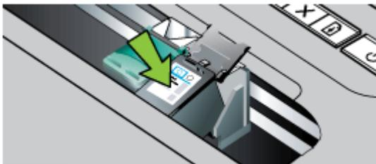
5. Feche a trava do cartucho de tinta. Se o cartucho estiver corretamente instalado, ao fechar a trava ele será ligeiramente empurrado, encaixando-se no seu
