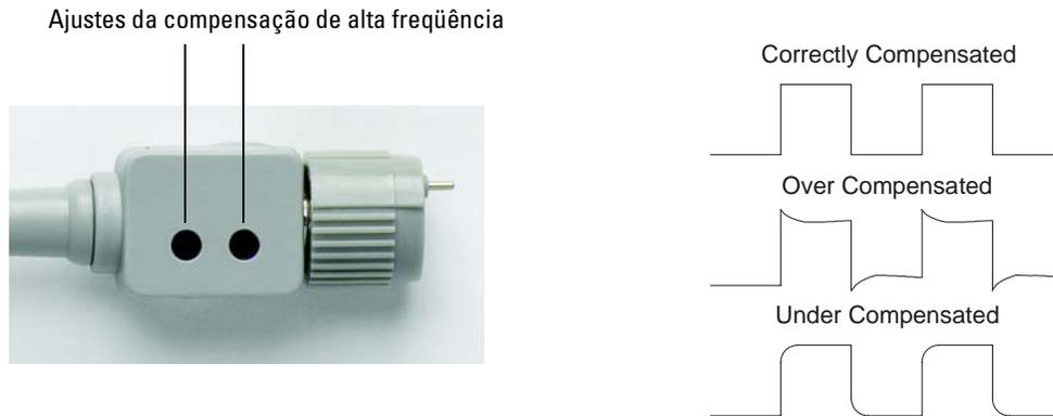
**Compensação da ponta de prova**
