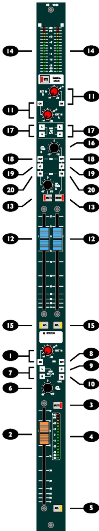
TALK TO OUTPUTS ou OSC TO OUTPUTS estiverem ativos. O interruptor acende para avisar que o OSC/TB está armado. A saída é diminuída em 6dB quando talkback estiver ativado. Alternativamente, se o sinal Master Talkback ou Oscillator já estiver ativado, pressionando OSC/TB direciona o sinal Talkback ou Oscillator para a saída, até o interruptor estar liberado.
