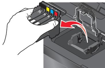
3 Limpe os contatos do cabeçote de impressão usando um pano limpo e sem fiapos.
