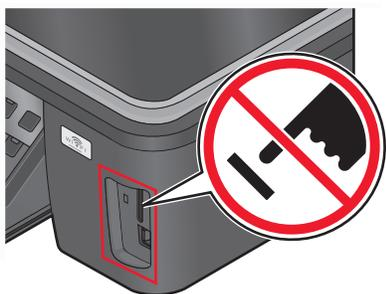
**Aviso—Dano Potencial:** não toque no cabo USB, em qualquer adaptador de rede, em qualquer conector, no dispositivo de memória ou nas áreas mostradas enquanto a impressora estiver imprimindo, lendo ou gravando do dispositivo de memória. Dados podem ser perdidos.
