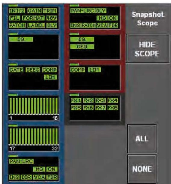
O Snapshot Scope (Escopo de instantâneo) GUI permite que o filtro do Snapshot Scope (Escopo de instantâneo) seja editado globalmente – pelo bloco de função ou grupo de parâmetros e pelo canal. Os botões de atalho no GUI permitem que <ALL> (todos) ou <NONE> (nenhum) dos grupos de parâmetro sejam selecionados ou desmarcados rapidamente no Escopo.
