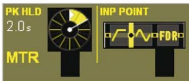
A configuração padrão. O Ponto do Decibelímetro está depois do corte digital e filtros, mas antes do Gate/EQ/Dynamics.
