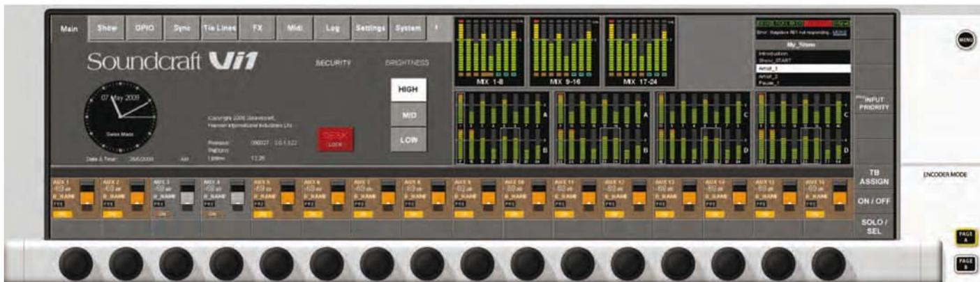
A configuração original para os codificadores VST Master é como os controles de nível de saída para as Saídas Master 1-16. Isto pode ser selecionado também quando se pressiona a tecla [PAGE A] no Painel do Modo Viconics Master (ver a Figura 7-6). Pressione [PAGE B] para que os codificadores VST sejam atribuídos como controles de nível de saída para as Saídas Master 17-24.
