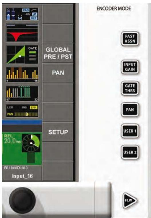
As teclas [FLW] ativam a função FOLLOW SOLO para a função da fileira de codificador. Isto significa que quando se pressiona um Solo/ sel de Saída, isto irá automaticamente atribuir a Saída em solo para esta fileira, anulando a seleção padrão ou a camada [USER].
