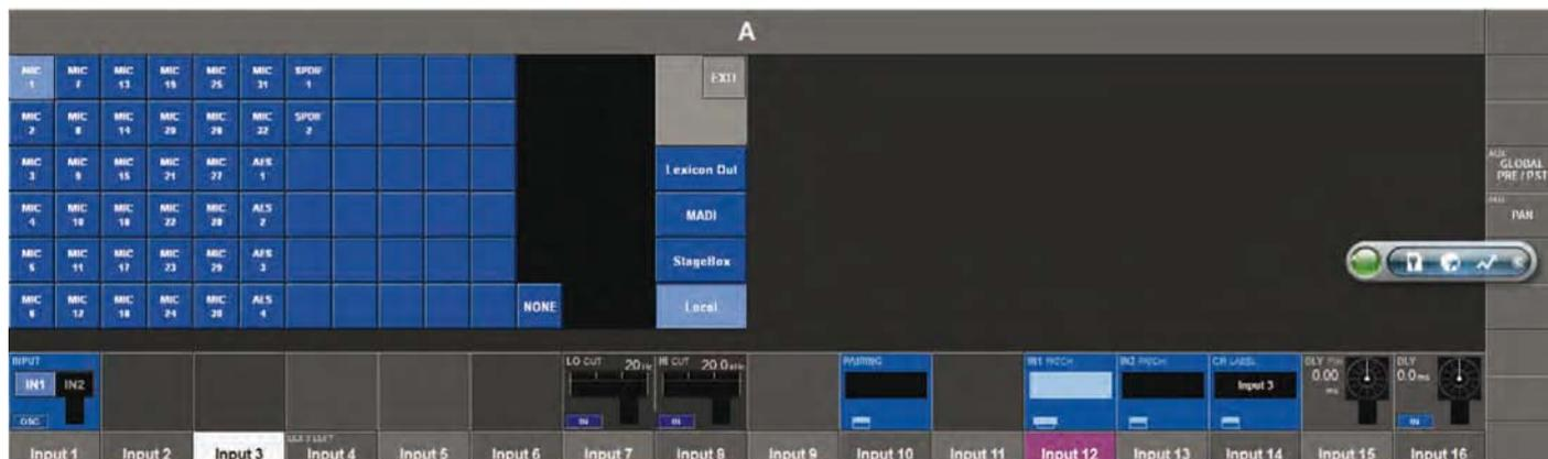
O Ponto da Correção de Entrada pode ser configurado individualmente para as Entradas IN1 e IN2 possíveis, utilizando o botão de configuração IN1 PATCH e IN2 PATCH.
