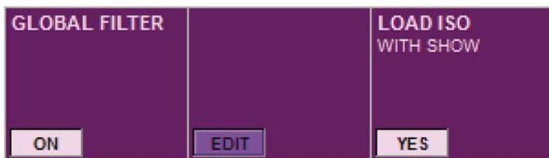
A tecla Master do Filtro Global {ON} é ativada assim que qualquer dos botões ISO no console for pressionado. Se o Filtro Global On for desabilitado, o estado de isolamento e todas as suas indicações na superfície serão removidas (incluindo as teclas [ISO] iluminadas e os gráficos Vistonics roxos). No entanto, seus estados serão mantidos na memória, permitindo que eles seja habilitados novamente posteriormente.
