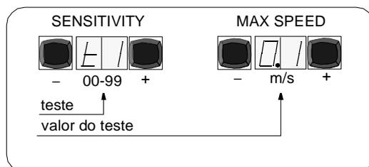
Figura 3-6. Indicação de valores de teste no painel
